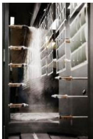
耐塩性、耐候性に優れるポリエステル樹脂の粉体塗装、100ミクロンの厚さで塗装します。
